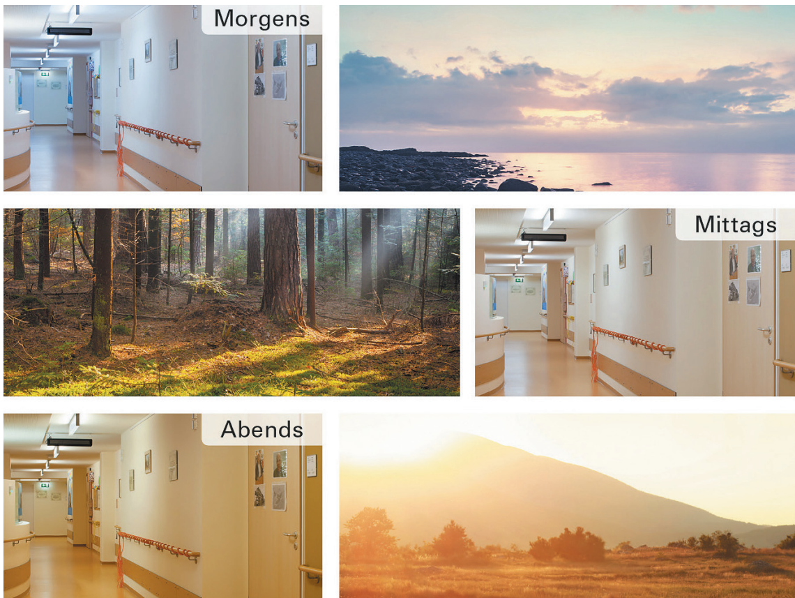
Abb. 20: Lichtsystem simuliert den natürlichen Tageslichtablauf
